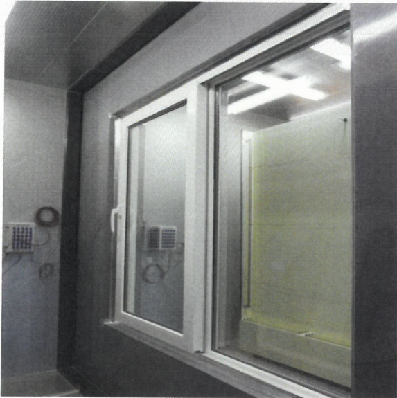
<사진 1> 열관류율 항온측 시험체 모습
