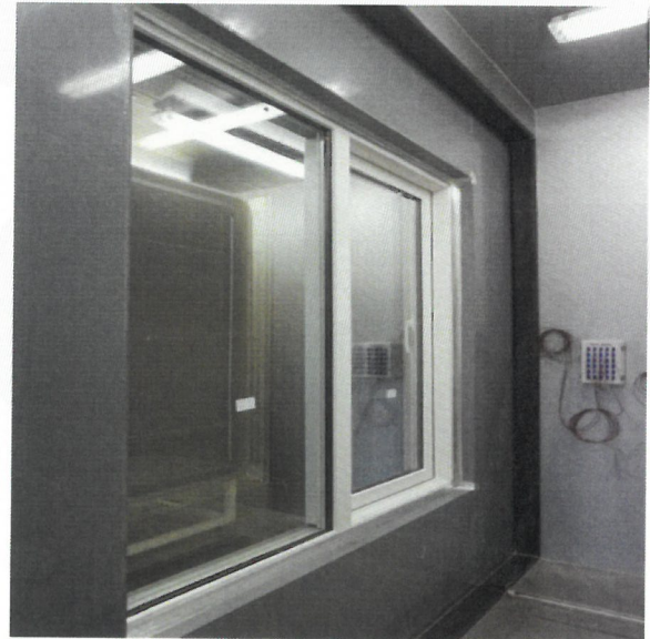
<사진 2> 열관류율 저온측 시험체 모습
